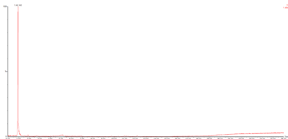
Figure 47: Chromatogramme en mode total ionique (TIC) par TD-GC-MS pour le contrôle air. L'analyse est réalisée dans un mode de screening non-ciblé (full scan).
