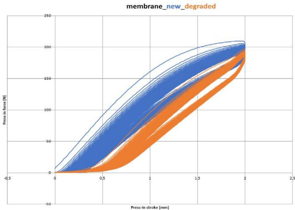
Figure 29 - Résultats des tests de compression comparatifs de la membrane usée versus une membrane neuve
