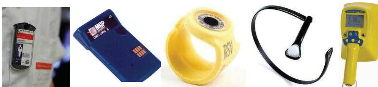
Figure 12: Exemples d'appareils de mesure des RI (de G à D: dosimètre passif de poitrine, dosimètre opérationnel de poitrine, dosimètre passif bague, dosimètre passif cristallin, contaminomètre)
