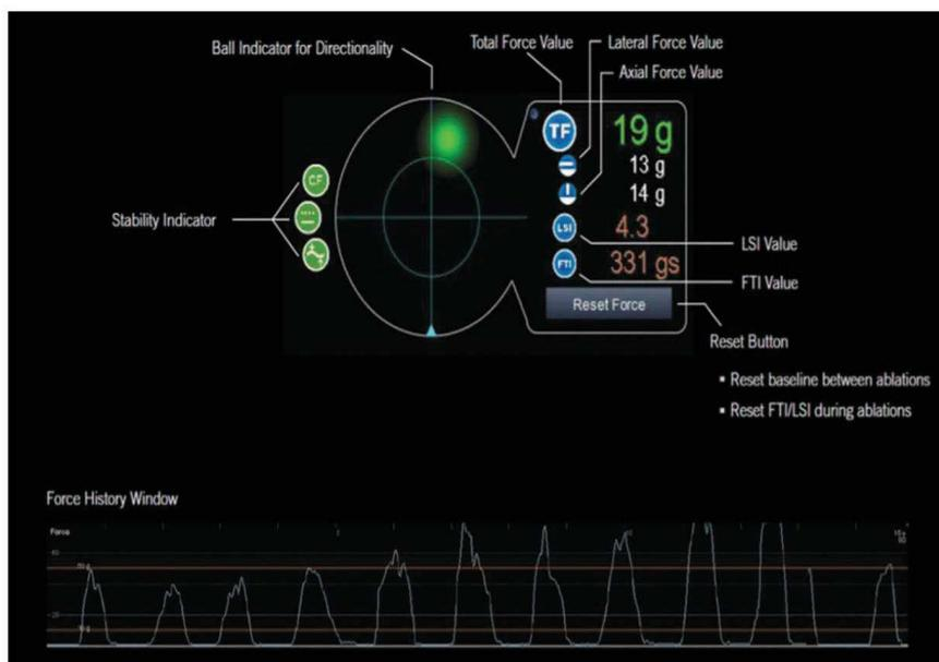
Figure 9 : Interface de guidage en temps réel combinant CF et FTI pour guider le geste d'ablation. (7)
