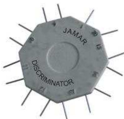
Figure 22 : Disque simplifié pour réalisation du test de Weber (Jamar ©,Duluth, Minnesota)
