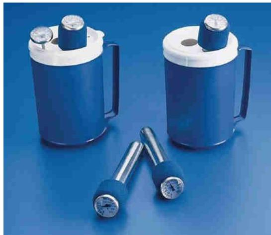
*Figure 14: Kit d'évaluation de la discrimination du chaud et du froid*
