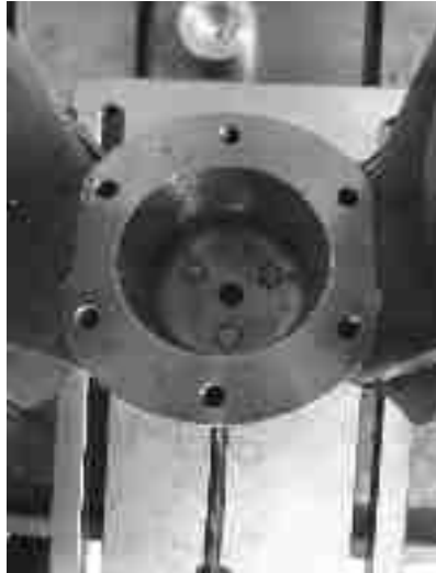
Figure 5 : Cupule métallique de maintien distal avec 6 vis (Vue supérieure)
