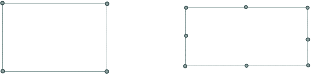
FIGURE II- 6 : EXEMPLE DE SOUS-DOMAINES RECTANGULAIRE DE DEGRE 1 (A GAUCHE) ET DE DEGRE 2 (A DROITE).
