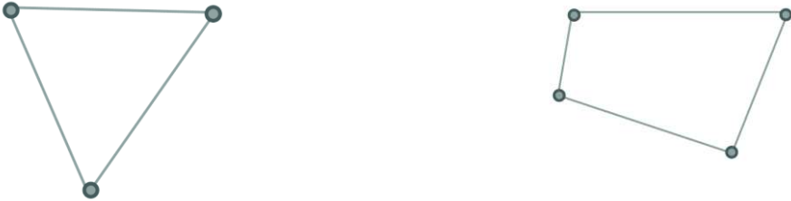
FIGURE II- 5 : EXEMPLE DE SOUS-DOMAINES A DEUX DIMENSIONS (TRIANGULAIRE A GAUCHE, QUADRANGULAIRE A DROITE)
