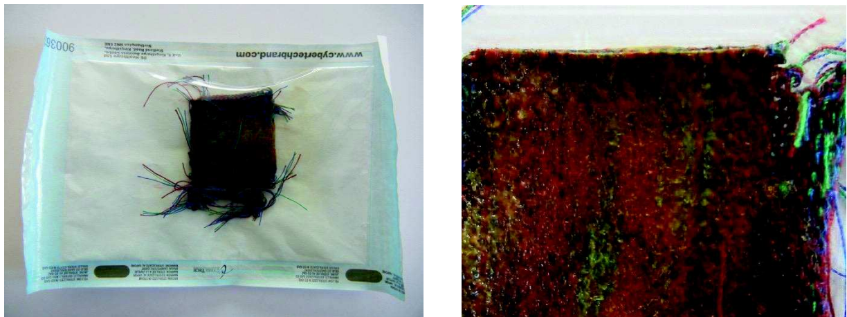
Figure 34 : Echantillon de l'échantillon de polyester enduit de silicone après passage dans l'autoclave.
