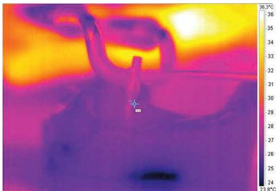
Analyse thermographique de la phase préparatoire, les deux électrodes sont maintenues en pression sans passage de courant.
