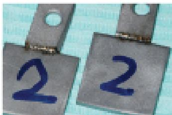
**GROUPE B : Plaques de titane pur soudées en bout à bout avec un laser Nd :Yag chair-side**
