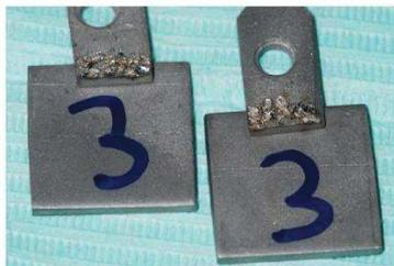
**GROUPE C : Plaques de titane pur soudées par syncrystallisation avec un recouvrement de 3mm ; electrowelder**
