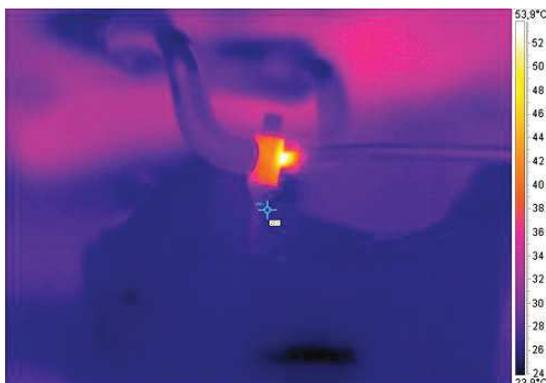
Analyse thermographique de la phase de soudure, les deux électrodes sont maintenues en pression pendant l'impulsion électrique de 2 à 5 ms.
