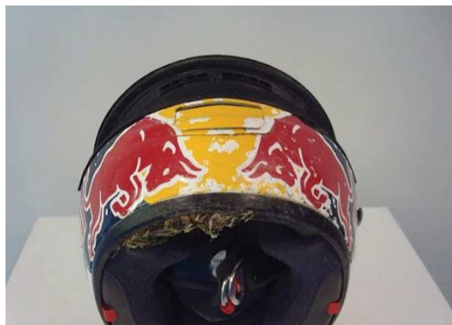
Figure 51 : Le casque du pilote après la chute (Francé, 2013).
