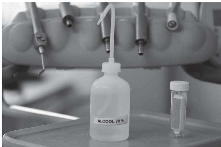
*Figure 8 Prélèvement d'eau au niveau des différents fouets de l'unit après passage d'une solution d'alcool au niveau des sorties d'eau (source personnelle)*
