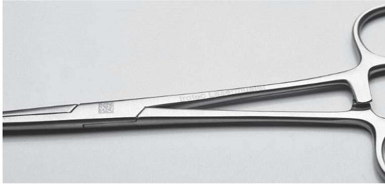
Figure 27 Marquage au laser d'un instrument chirurgical (39)
