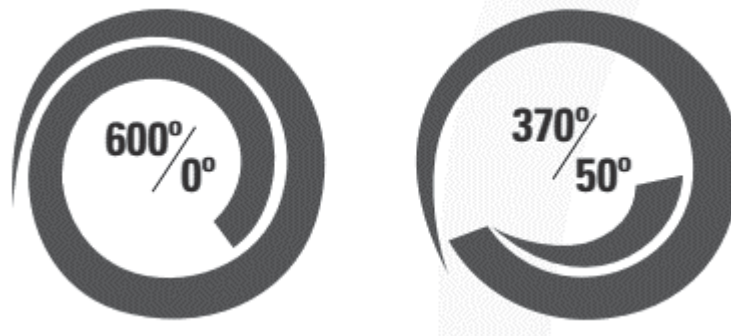
Figure 13 : Schéma présentant le mouvement hybride : à gauche le mouvement type rotation continue et à droite le mouvement type réciproque(37).
