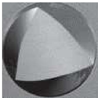
Figure 12 : Coupe transversale de la partie coronaire des instruments WaveOne® (38).
