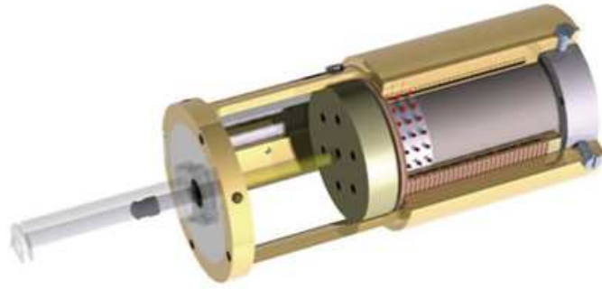
Figure 4 : Schéma d'un mécanisme utilisant la force de Lorentz
