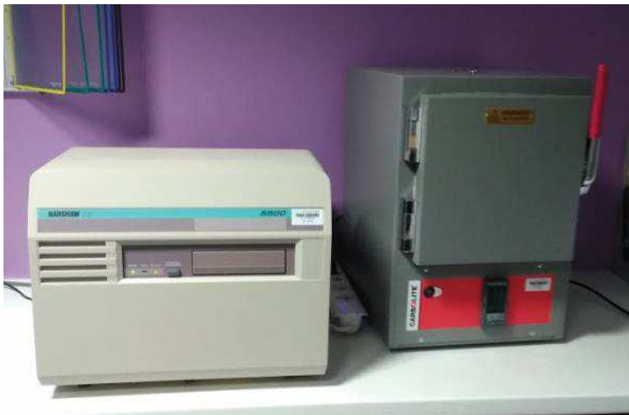
Figure 17 : Lecteur de TLD Harshaw 5500 à gauche et four Carbolite à droite
