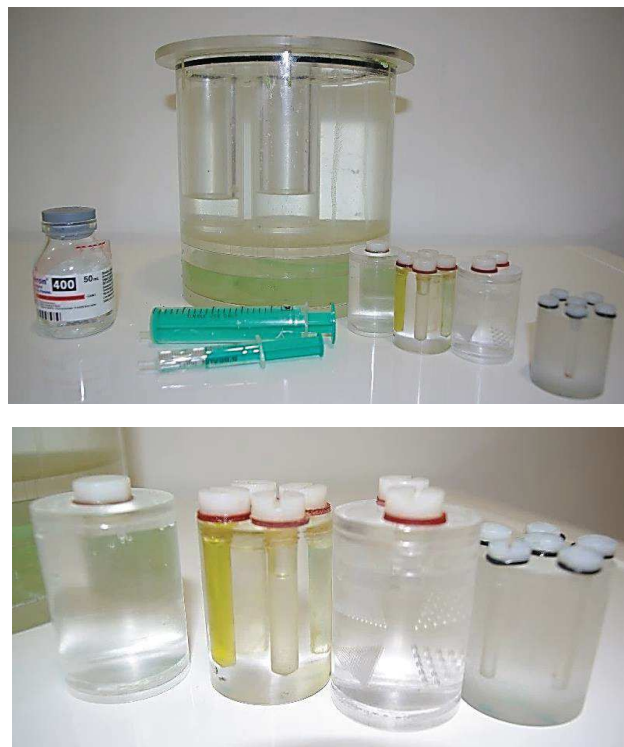
Figure 10 : Fantômes du Dr Dillenseger et collaborateurs. En haut, le cylindre en plexiglas principal pouvant contenir les quatre modules
