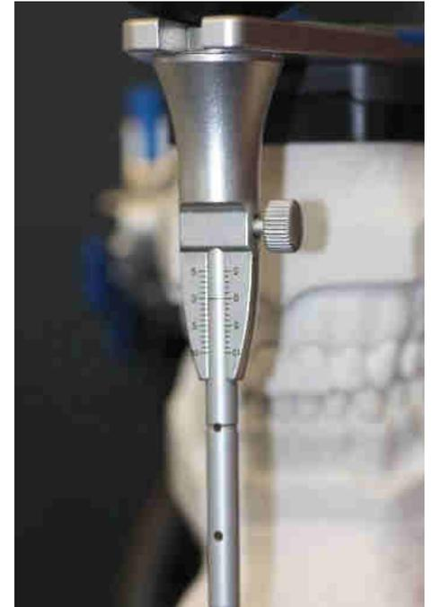
Figure 34 : Vérification du réglage de la tige à 0mm
