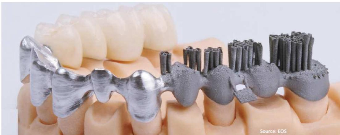
Figure 1.16 : bridge complet dont l'armature est imprimée. Le métal est, de droite à gauche, brut, poli et céramisé.
