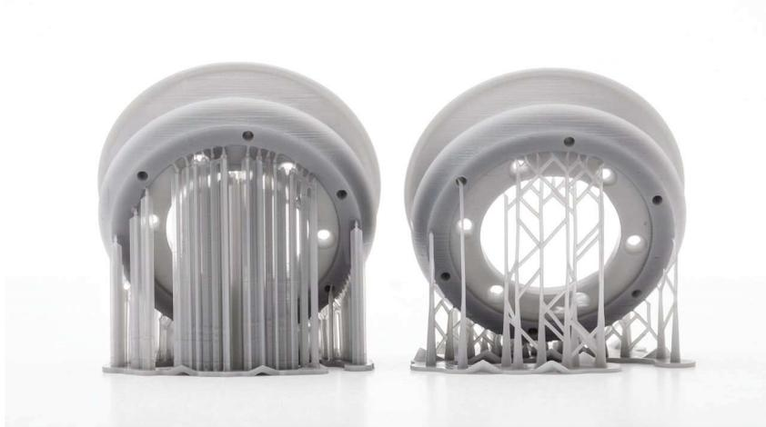
Figure 1.20 : deux dispositions différentes de supports d'impression
