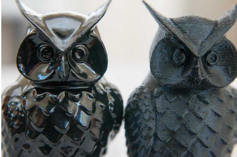
Figure 1.17 : pièce en ABS après et avant traitement par acétone
