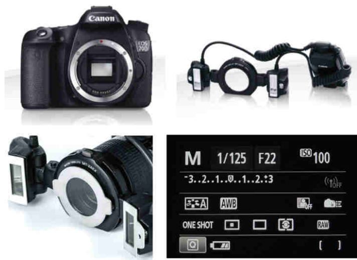
Figure 12 : Boîtier Canon EOS 70D, flash Canon MT24EX, filtres de polarisation Polar Eyes apposés sur une optique macro et paramètres de réglage manuel
