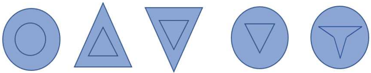
Figure 116 Illustration de différentes pointes d'aiguilles. Réalisation personnelle. De gauche à droite nous distinguons la pointe ronde, triangulaire, triangulaire à coupe inversé, la pointe « taper cut » et la pointe « multipass ».
