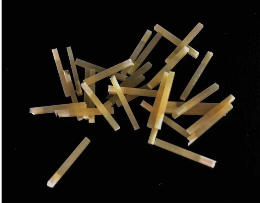
Figure 18 : sticks obtenus avant les tests de micro-traction. Iconographie personnelle.
