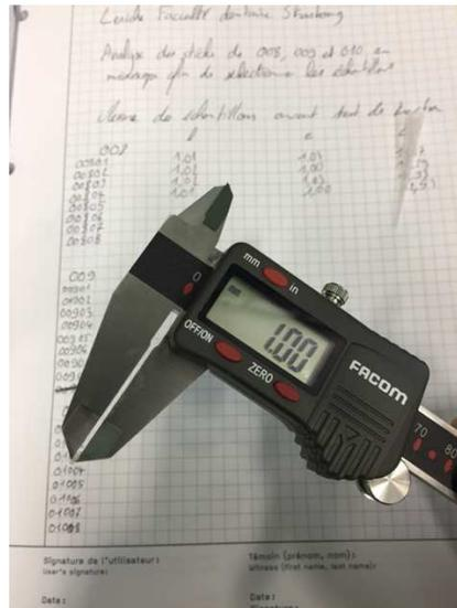
Figure 22 : Mesure de la section de la section de chaque échantillon au pied à coulisse. Iconographie personnelle.
