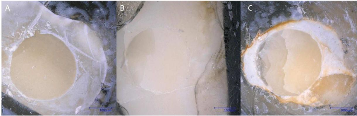
Figure 33 : Photos représentant l'observation au microscope optique des surfaces amélaire après les tests de cisaillement. **A** : rupture adhésive ; **B** : rupture mixte entre l'adhésif et la couche de composite ; **C** : rupture cohésive dans la couche composite. (Grossissement x50). Iconographie personnelle-laboratoire INSERM UMRS 1121.
