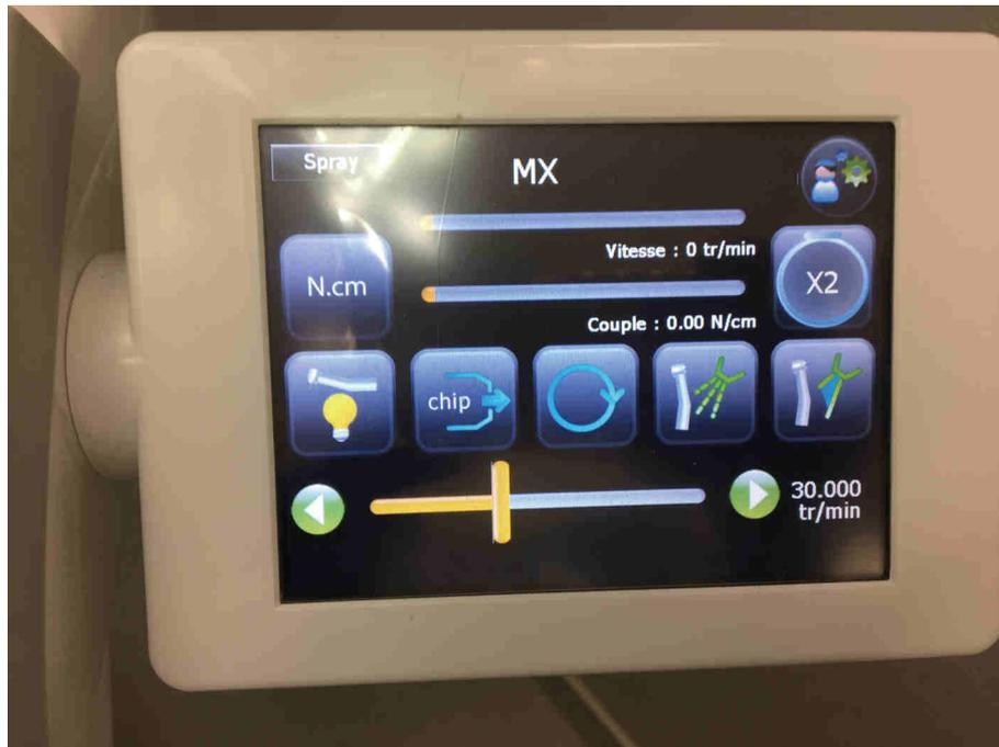
**Figure 24** : Photo des paramètres du micromoteur utilisés pour le polissage du 1<sup>er</sup> groupe
