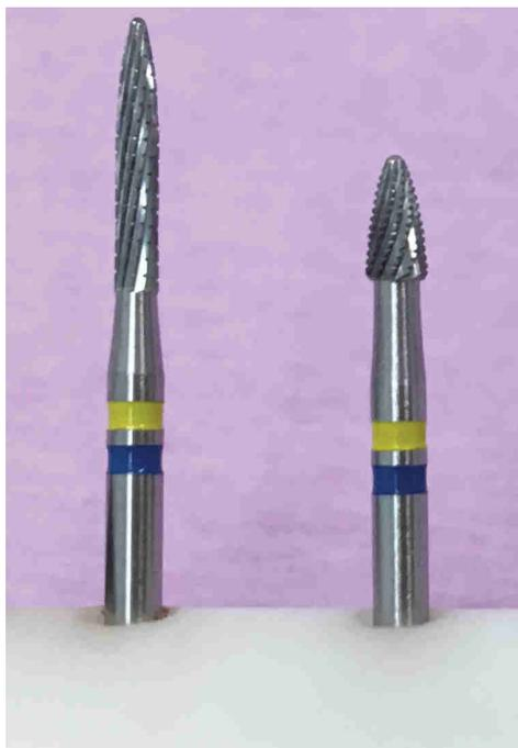
**Figure 10** : Photo des fraises multi-lames (Komet) utilisées pour la finition
