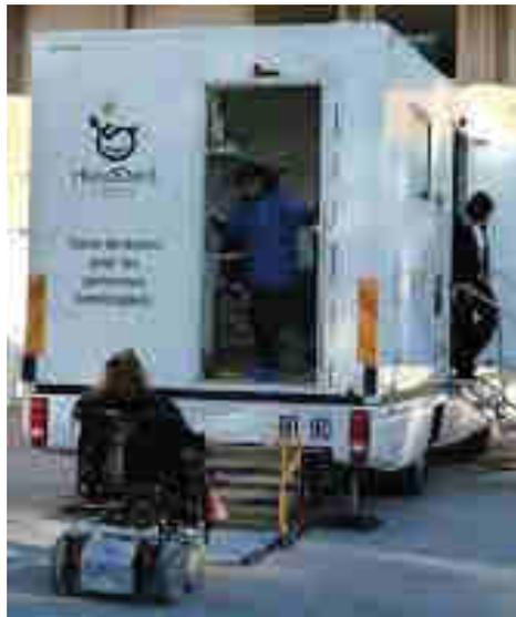
Figure 20 : Le hayon élévateur à l'arrière du bus et l'escalier escamotable sur le côté (44)
