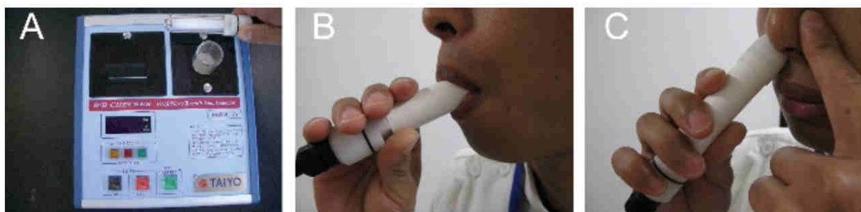
Figure 28 : photo d'un B/B Checker. A : corps principal contenant une imprimante. B : mesure intra-orale. C : mesure intra-nasale. (75)
