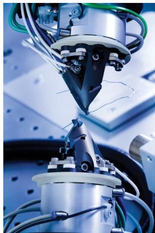
Figure 52 : système SureSmile® - arc plié robotiquement (94).
