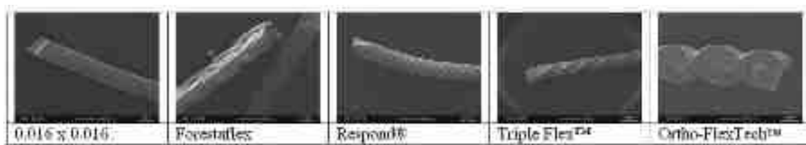
Figure 41 : Images au microscope électronique à balayage de certains fils testés dans l'étude d'Arnold et collaborateurs (30).
