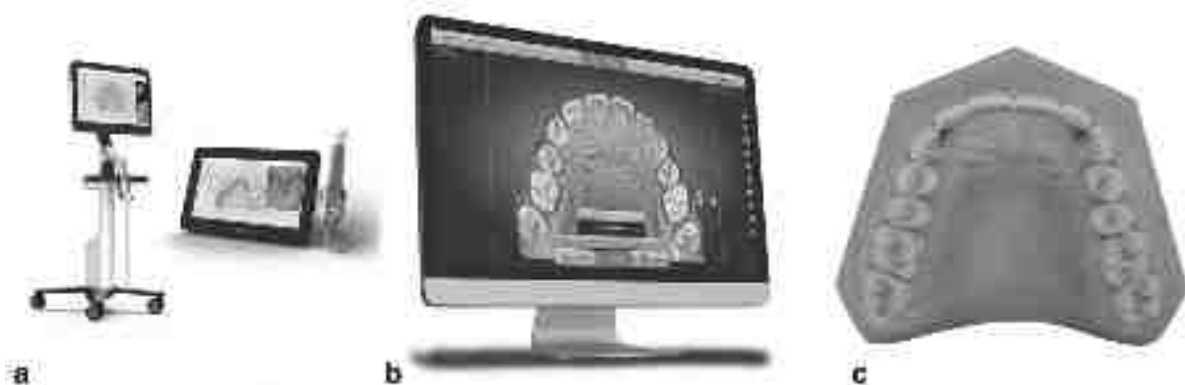
Figure 26 : CFAO avec robot plieur. a) Importation du scan. b) Conception du fil. c) Production du fil. (85)
