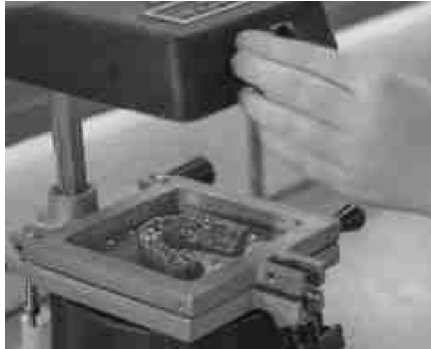
Figure 19 : Réalisation d'une gouttière thermoformée (71)
