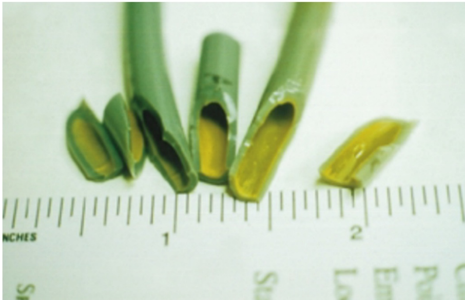
Figure 8 : formation de biofilm sur la paroi interne de la conduite d'eau (6)
