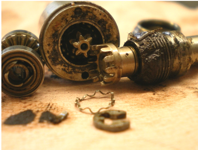
Figure 11 : PID démonté avec salissures internes et externes (39)
