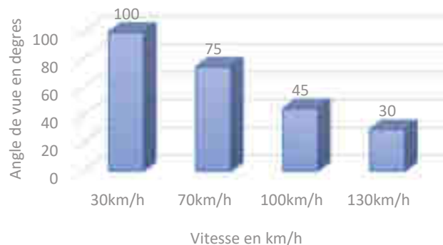
Figure 2- Angle de vue en degré en fonction de la vitesse du conducteur en km/h (5)
