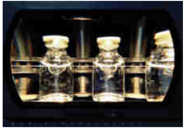
Figure 21 : Inspection visuelle des préparations injectables [51]
