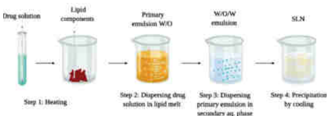
Figure 66 : Principe de fonctionnement de la méthode à double émulsion E/H/E. [241]
