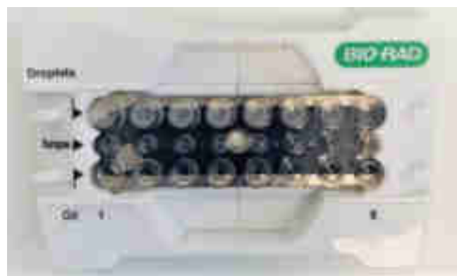
Figure 16 : Photographie de l'aspect blanchâtre des puits lors du contrôle visuel de l'étape d'émulsion de la ddPCR.
