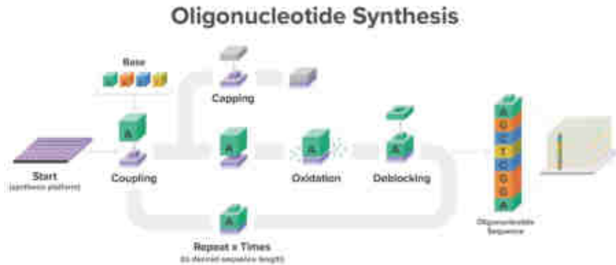
Figure 12 : Représentation d'un cycle de synthèse chimique d'ADN [68]
