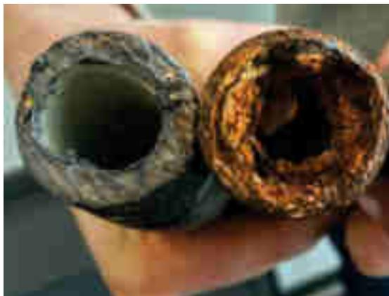
Figure 12 : Photo comparative de tuyaux utilisés dans l'industrie agroalimentaire avec présence de biofilm et tuyau sans biofilm. (24)
