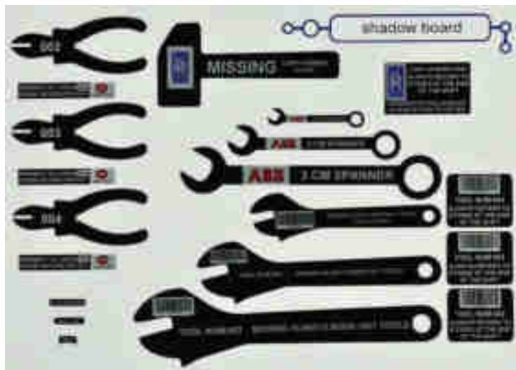
Figure 18 : Panneau à outils avec silhouettes ou shadow board.
