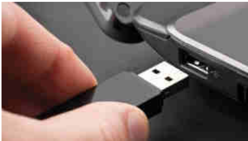
Figure 8 : Exemple de détrompeur de contact : Système USB
