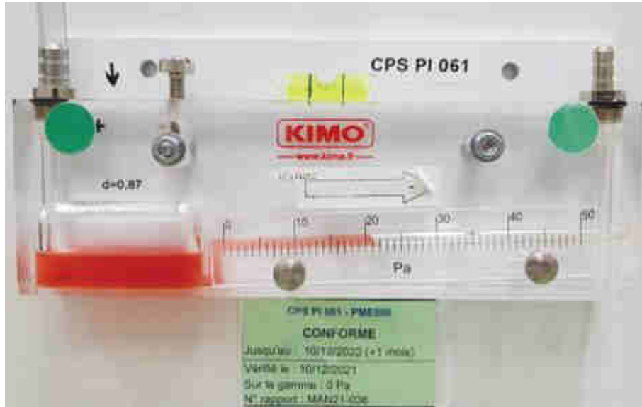
Figure 43 : Manomètre avant harmonisation :
