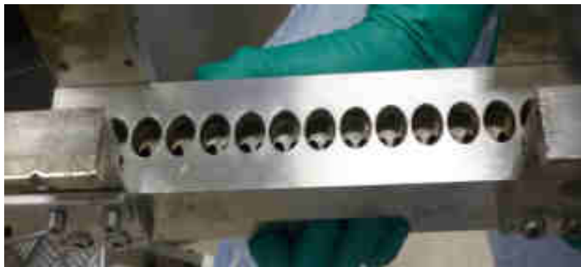
Figure 8 : Exemple de collecteur de condensats
