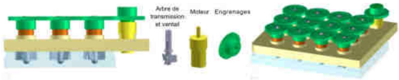
Figure 20 : Dessin assisté par ordinateur du bioréacteur Spin  $\Omega$  en version 12 puits et des pièces individuelles de la conception<sup>66</sup>
