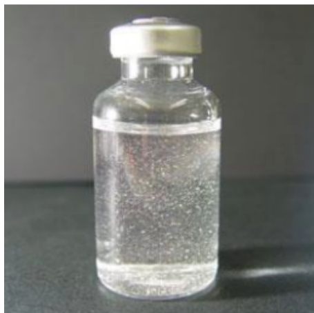
Figure 23 : Exemple d'un flacon en verre contenant une solution basique et sujet au phénomène de délamination du verre
