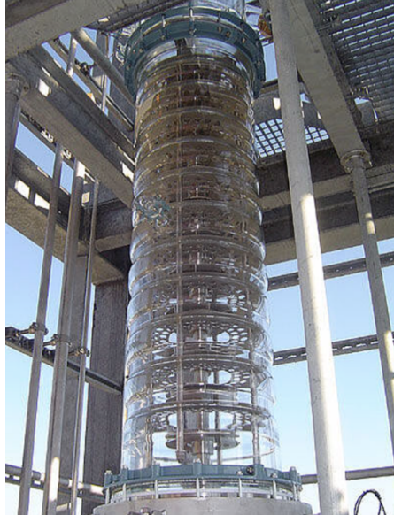
Figure 4 : Colonne d'extraction DN400 liquide/liquide (32)
