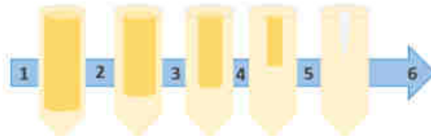
Figure 26: Schéma du refroidissement progressif du suppositoire au sein des 4 frigos de la remplisseuse S2
