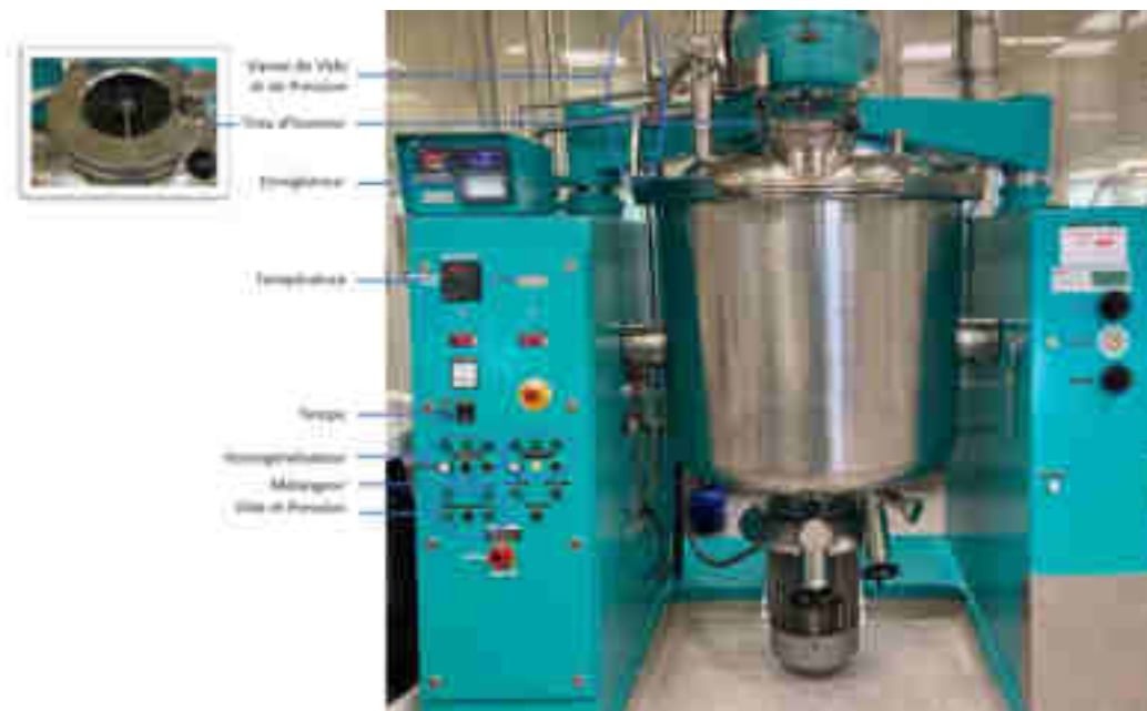
Figure 17: Photo avec légende d'une cuve de fabrication Moltomat 300L localisé en fabrication à Delpharm HUNINGUE
